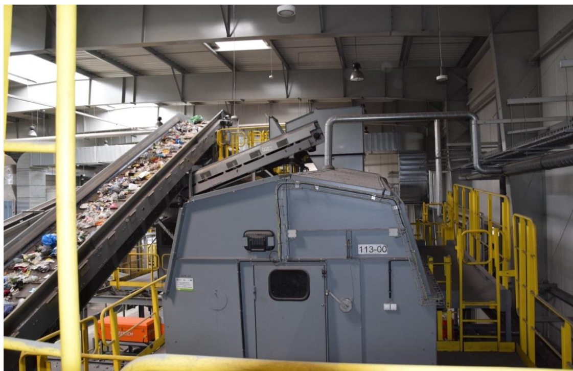
Fotografia 4. Zakład mechaniczno-biologicznego przetwarzania odpadów komunalnych w Stalowej Woli - przenośniki taśmowe i przesiewacz bębnowy do separacji odpadów w hali sortowniczej
